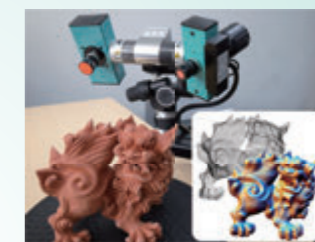
3Dスキャニング技術による 実物形状のデジタル化
